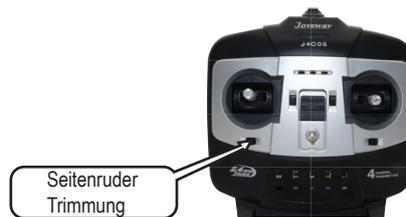
1. Lassen Sie die Steuerknüppel los. Wenn das Flugzeug sich nach links bewegt, stellen Sie die Seitenrudertrimmung nach rechts ein.
