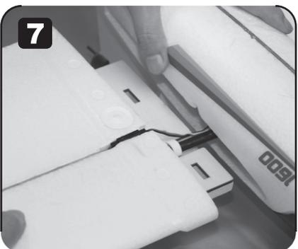
8. Schieben Sie die rechte und linke Tragfläche wie auf dem Foto gezeigt zusammen. Achten Sie darauf, dass das V-Kabel nicht eingeklemmt wird.
