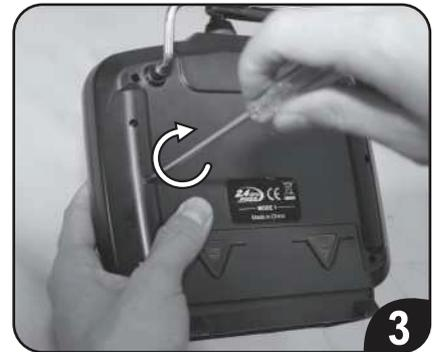
Schritt 4: Drehen Sie die Schraube unten rechts vollständig heraus, bis der Schraubenkopf fast mit der Rückwand abschließt.
