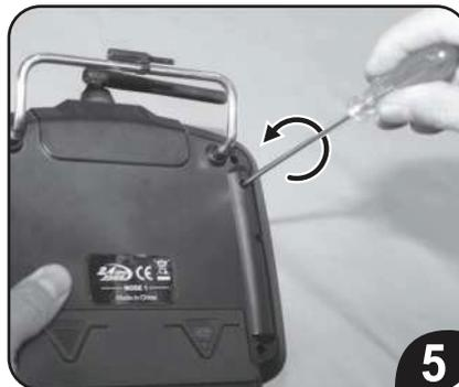
Hinweis: Wenn Sie von MODE 1 auf MODE 2 zurückbauen wollen, schalten Sie zuerst den MODE-Knopf unter dem Batteriehalter auf MODE 2. Lösen Sie die beiden linken Schrauben und ziehen Sie die beiden rechten Schrauben an, bis die gewünschte Rückstellkraft erreicht ist und der Gas- und Höhenruderknüppel wieder wie gewünscht arbeitet.
